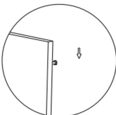
7.3 Installiere die Messsonde auf die Wand anhand des Doppelklebebandes und lasse keinen Spalt zwischen dem Fußboden und der Messsonde.
