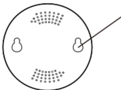
2) Montiere die beiden Schrauben aus dem Paket und behalte eine Spalte von 5-8 mm bis zur Wand. Danach befestige auch das Gerät.
