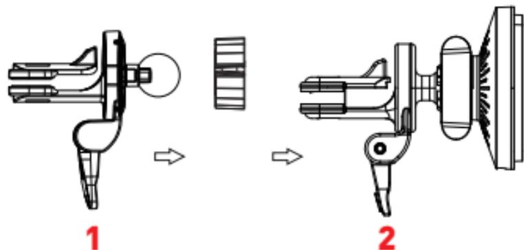
1. Posizionare il dado di fissaggio sulla pallina rotativa del morsetto di montaggio.
