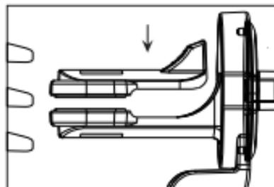
3. Insérez le clip de montage dans la lame d'aération de la voiture.
