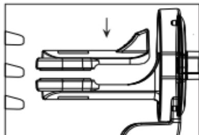
3. Inserte el clip de montaje en la hoja de ventilación de aire del coche.
