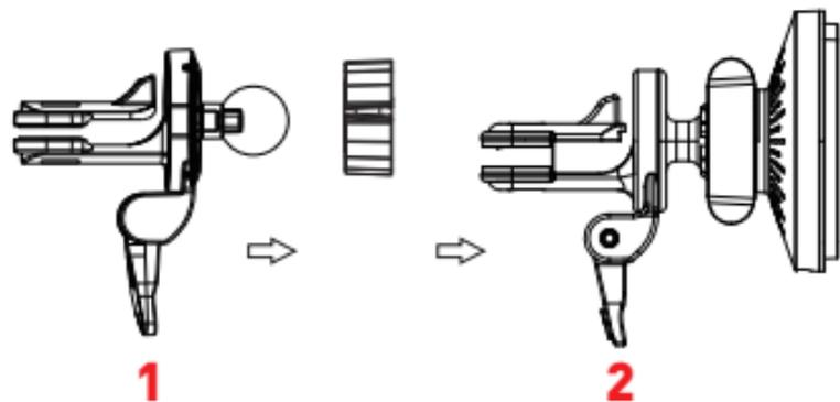
1. Coloque la tuerca de fijación en la bola giratoria del clip de montaje del respiradero.
